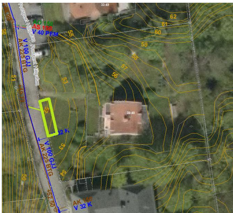
Figur 14. Föreslagen placering av makadammagasin för fastighet 33:48 (för djup 0,6 m, längd 11 m och bredd 2,5 m).
