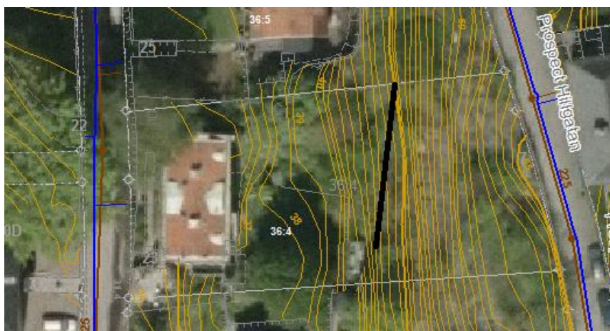
Figur 16. Dagvattenlösning för Fastighet Gårda 36:4. Den svarta linjen visar föreslagna placeringen av vattenfall med störst volym i söder och minst i norr med verklig längd av 20 m.
